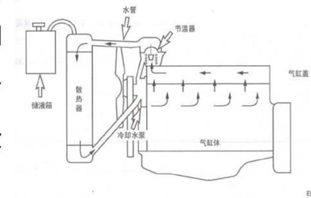
如果引擎水溫異常，溫度過高需檢查風扇皮帶是否鬆動，水箱是否有污物導致散熱不良，另引擎內的節溫器是否未開啟，如未開啟熱水無法循環散熱，將導致高水溫跳機。
