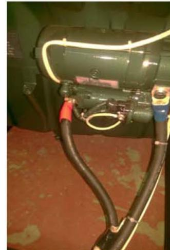
**啟動馬達本體**一般如果無法啟動引擎(電瓶電力足)，即表示**啟動馬達**故障需更換新品或送修。
